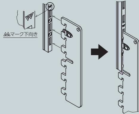
③ 手順①に手順②分を上から落とし込むようにセットし上下のチャンネルサポートの垂直を出してから上側のチャンネルサポートをビス止め固定してください。
