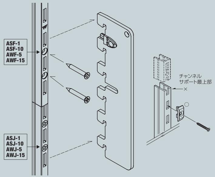
※チャンネルサポート ASF-1/10・AWF-5/15 の最上部断面は、製造工程上、通常のスリット穴部より分厚くなっているため誤って床面側に取り付けされると、連結部のスリット穴にブラケットの爪が確実に落ち込まず危険です。その為、ASJ-1/10・AWJ-5/15 を床面側に取り付けて ASF-1/10・AWF-5/15 は必ず“上下逆使い”にて天井面側に取り付ける必要があります。
