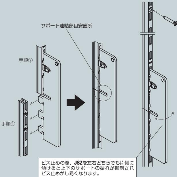
ビス止めの際、JSZを左右どちらでも片側に傾けると上下のサポートの振れが抑制されビス止めがし易くなります。
