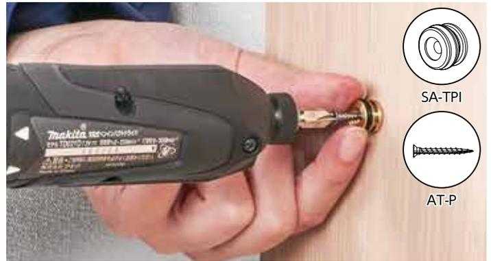
妻板にAタッピング (AT-P) を使ってタッピング用インローダボ (SA-TPI) を取り付けます。
