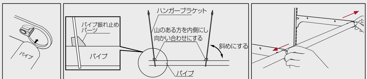
パイプを挿入します 左右のブラケットを上図のように通し、壁面のサポートに設置します ブラケットの先端を持ち、外側へ広げます
