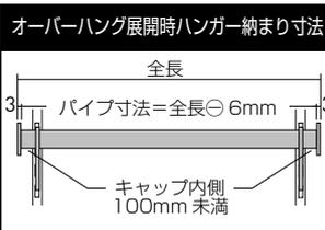
ハンガーパイプの寸法はエンドパーツの厚み分(3mmずつ計6mm)をマイナスした寸法でご注文ください。
