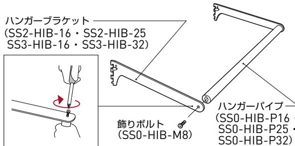
サポートのスリットにハンガーブラケットを差し込み、左右の高さが同じであることを確認し、爪部をしっかりと落とし込んでください。
