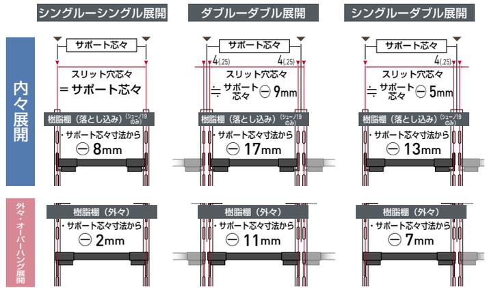
ワイド 598 および 898 には補強用の鉄芯が入っています。鉄芯を抜き出し、樹脂棚本体をカットしてください。
