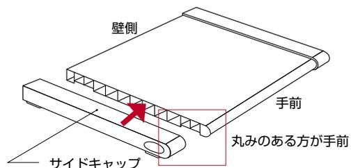
木棚ブラケット (SS2-WOB-R/L または SS2-WIB-R/L) の棚受け部をサイドキャップの差し込み口へ、外側から内側に向けて差し込みます。
