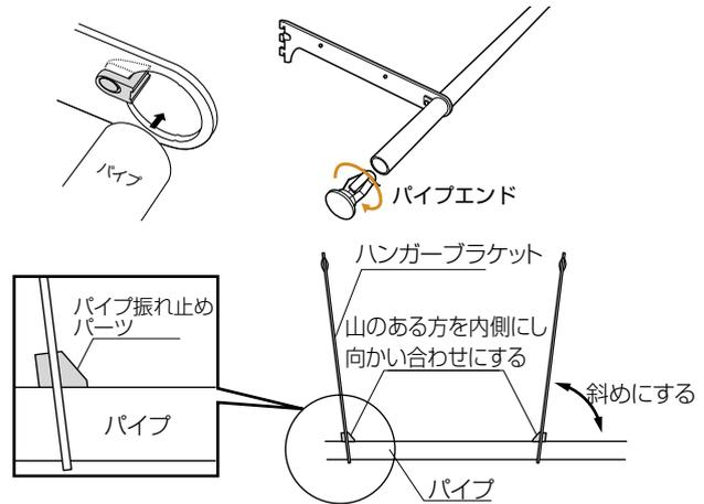
「ハンガーブラケット」は左右があります。右図のように、パイプ振れ止めパーツの山側がそれぞれ内側に向くようにパイプをハンガーブラケットに通します。その際、パイプは斜め方向に挿し込むと通りやすくなります。
