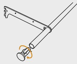
ハンガーブラケット (SS3-HOB-32RL) にパイプ (SS0-HOB-P32) を通し、エンドパーツ (SS0-HOB-E32) を挿入します。エンドパーツは回すことで締め込まれ固定されます。
