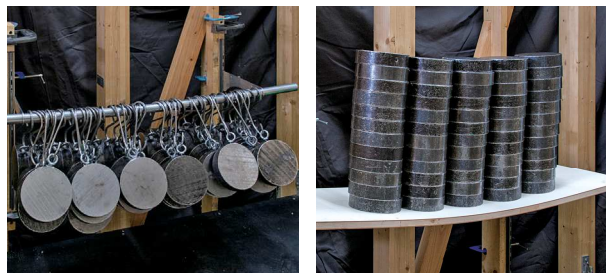
ブラケットの前垂れ角度・重量テスト・たわみテスト状況
