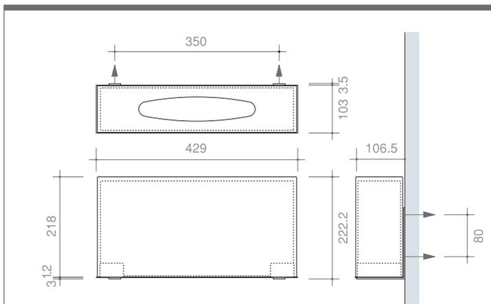
壁面取付けタイプ 詳細図
