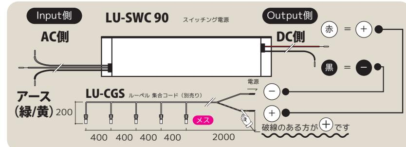
■ラインコンセント等との結線については有資格者による施工が義務付けられていますので、専門業者にご依頼下さい。一般の方の電気工事は法律で禁止されています。
