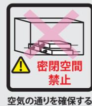
アダプタ自体 (LU-AD-CT) の発熱により、隣り合わせで使用したり、密閉された狭い空間で使用すると、熱により内部部品の故障の原因となる可能性があります。そのため左図のような条件では使用しないようにしてください。
