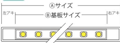
$$\text{(A)サイズ} - \text{(B)基板サイズ} \div 2 = \text{片側アキ寸法}$$
