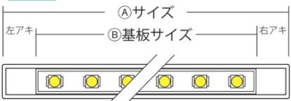
$$(\text{Aサイズ} - \text{B基板サイズ}) \div 2 = \text{片側アキ寸法}$$
