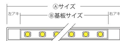
$$\frac{(\text{Aサイズ} - \text{B基板サイズ})}{2} = \text{片側アキ寸法}$$
