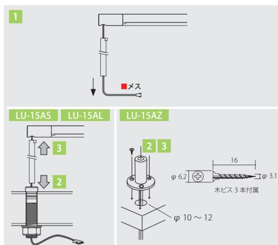
2 「A座面を施工する」の工程で固定した打ち込みボルト座金(Sタイプ・Lタイプ・Zタイプ)へコードを通し、スタンドパイプを差し込んでください。
