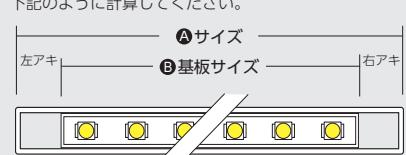
$$(A \text{ サイズ} - B \text{ 基板サイズ}) \div 2 = \text{片側アキ寸法}$$
